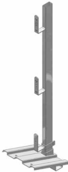
Fig. 9.1.2.1.2-2 Parapetto provvisorio ammorsato con piastra inclinata
