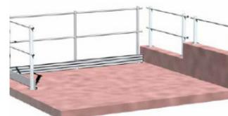
Parapetti con interasse massimo pari a 150 cm se conformi alla norma UNI EN 14122:2010 oppure con interasse massimo pari a 70 cm se conformi alle NTC 2018, con carico orizzontale pari ad 1 kN/m.
