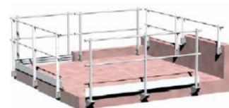
Parapetti con interasse massimo pari a 150 cm se conformi alla norma UNI EN 14122:2010 oppure con interasse massimo pari a 70 cm se conformi alle NTC 2018, con carico orizzontale pari ad 1 kN/m.
