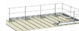
Parapetti con interasse massimo pari a 150 cm se conformi alla norma UNI EN 14122:2010. Il fissaggio di questa tipologia di parapetto avviene mediante l'utilizzo di elementi in acciaio inox rivettati al manto di copertura, evitando eventuali problematiche legate all'infiltrazione dell'acqua.
