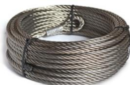
Fune ø 8 mm in acciaio inox 316 composto da 7x19 trefoli, che ne consente una maneggevolezza elevata. L'operatore connette il proprio moschettone al cavo per spostarsi in sicurezza con la massima ergonomicità.
