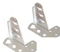
Coppia di elementi di estremità dei dispositivi della gamma Extra tipo C dal design innovativo. La loro particolare geometria è stata studiata per deformarsi in caso di caduta, assorbendo così parte dell'energia cinetica che si va a sviluppare. Le forme presenti sulla base evitano di creare interferenza tra la testa dei rivetti e le partenze warp.
