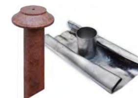
Insieme di accessori impermeabilizzanti per i pali e vengono utilizzati per impedire le infiltrazioni d'acqua al termine del montaggio. Sono disponibili nella versione piana ( da utilizzare quando il palo ha base piana o doppia inclinazione) o inclinata (da utilizzare quando il palo ha base inclinata).
