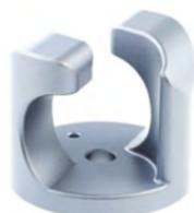
Elemento da installare qualora la lunghezza della fune sia maggiore di 20 metri. La sua particolare forma ne consente il superamento senza dover utilizzare il doppio cordino.
