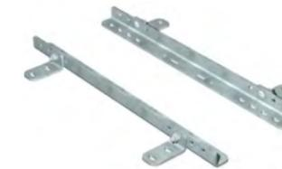
Elemento studiato per ripartire il carico sulla struttura secondaria qualora non sia possibile eseguire l'installazione sulla quella primaria. Composto da una coppia di angolari principali e 4 angolari aggiuntivi per aumentare il numero di fissaggi, in ferro 275 JR.
